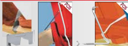
Entsprechend den Fachregeln liefern wir Sturmklammern für die einfache und effektive Windsogsicherung. Alternativ zum Verklemmen mit der Lattung oder zum Einschlagen in die Lattung. Korrosionsbeständig durch Edelstahl-draht 1.4310 (A2) oder ZIAL®-Beschichtung (Korrosionsschutz).
