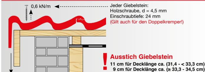
Der Abstand zwischen Innenkante Ortganglappen zur Außenkante Giebelwand bzw. Außenkante Bekleidung oder Unterkonstruktion, muss mindestens 1 cm betragen. (Der Überstand von Doppelkremplern oder Flächensteinen über Außenkante Giebelwand bzw. Außenkante Bekleidung oder Unterkonstruktion muss mind. 3 cm betragen.)
