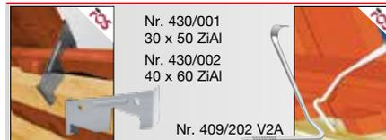
Entsprechend den Fachregeln liefern wir Sturmklammern für die einfache und effektive Windsogsicherung. Alternativ zum Verklemmen mit der Lattung oder zum Einschlagen in die Lattung, Korrosionsbeständig durch Edelstahl-draht 1.4310 (A2) oder ZIAl<sup>®</sup>-Beschichtung (Korrosionsschutz).
