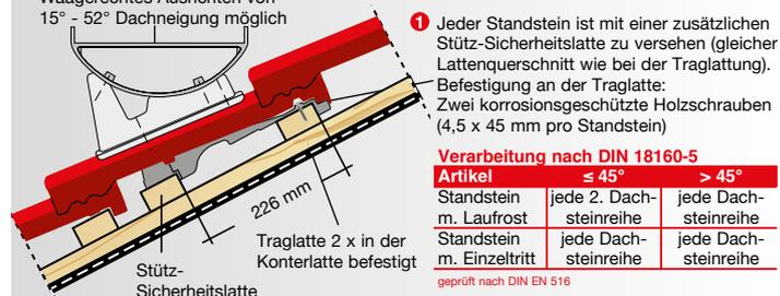
2 „Alu-Pfannen“ mit Schneefangstütze oder Rundholzhalterung werden mit Stützlatte verlegt. Die Stützlatte wird direkt unterhalb der Traglatte montiert.
