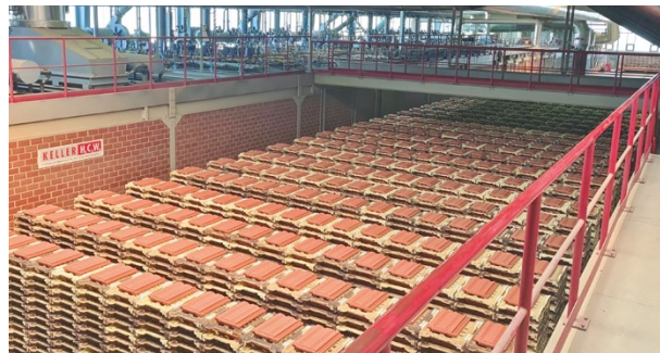
Moderne H-Kassetten auf dem Brennwagen.
